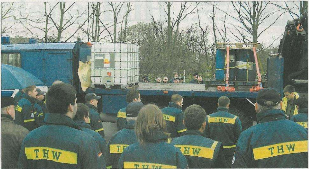
Nach dem Bremsversuch ist auf der Ladefläche des Hildesheimer THW-Lastwagens zu erkennen: Ein ungesicherter Wassertank ist gerutscht, die gesicherten Fässer auf der Palette haben sich nicht bewegt.
